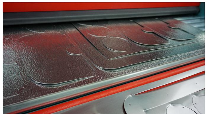
Zuschnitte direkt ab Band: Praktisch keinen Verschnitt. Inklusive Blechoptimierung (Nesting), um die optimale Blechausnutzung zu erzielen. Sparen Sie beim Material - und nicht an der Maschine.
