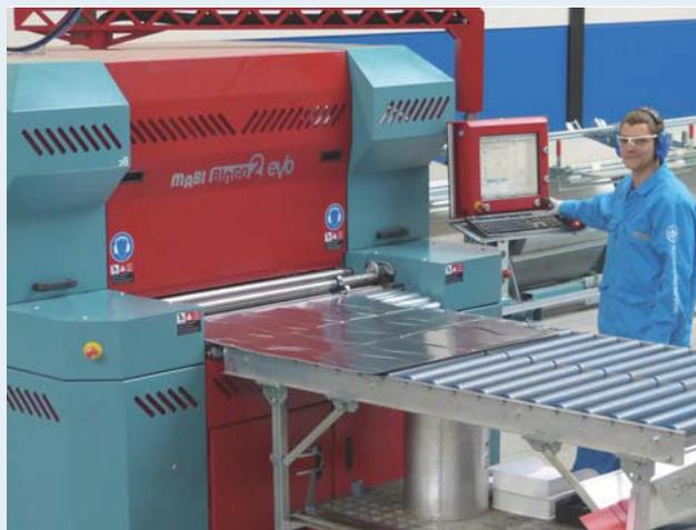
*Zum Schneiden von Formstücken verwendet Bilfinger Mabis patentiertes Topmodell Bingo 2 EVO, einen vollautomatischen Alleskönner für Isolierbleche: Doppeltes Schneidsystem, automatische Breitereinstellung, Produktcodierung mit schnell trocknender Tinte, Optimierung für die Blechbelegung (Nesting) und Online-Programmierung. Die Maschine kann vollständig bei der Arbeitsvorbereitung programmiert werden. Hierbei können auch die Codiertexte angepasst oder erweitert werden.*
