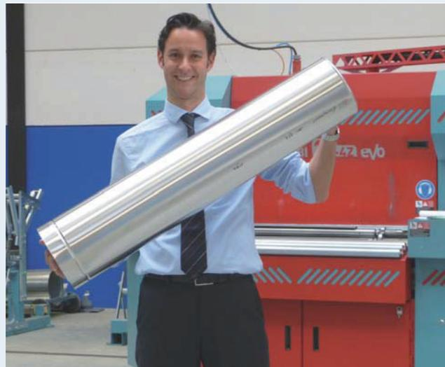
*Mabi-Geschäftsführer Markus Biland, mit der 16 4Z-EVO im Hintergrund, auch „Rohrblitz“ genannt. Diese Maschine ist vollständig auf die Massenproduktion und Einzelfertigung von Isolierrohren und Zuschnitten abgestimmt. In einem vollständig automatisierten Arbeitsgang finden nacheinander Richten, Schneiden, Lochen, Sicken und Runden statt. Alle gängigen Materialabmessungen und -sorten – natürlich auch Inox – können bearbeitet werden. Auch in der jetzt aufkommenden Blechbreite 1250 mm.*
